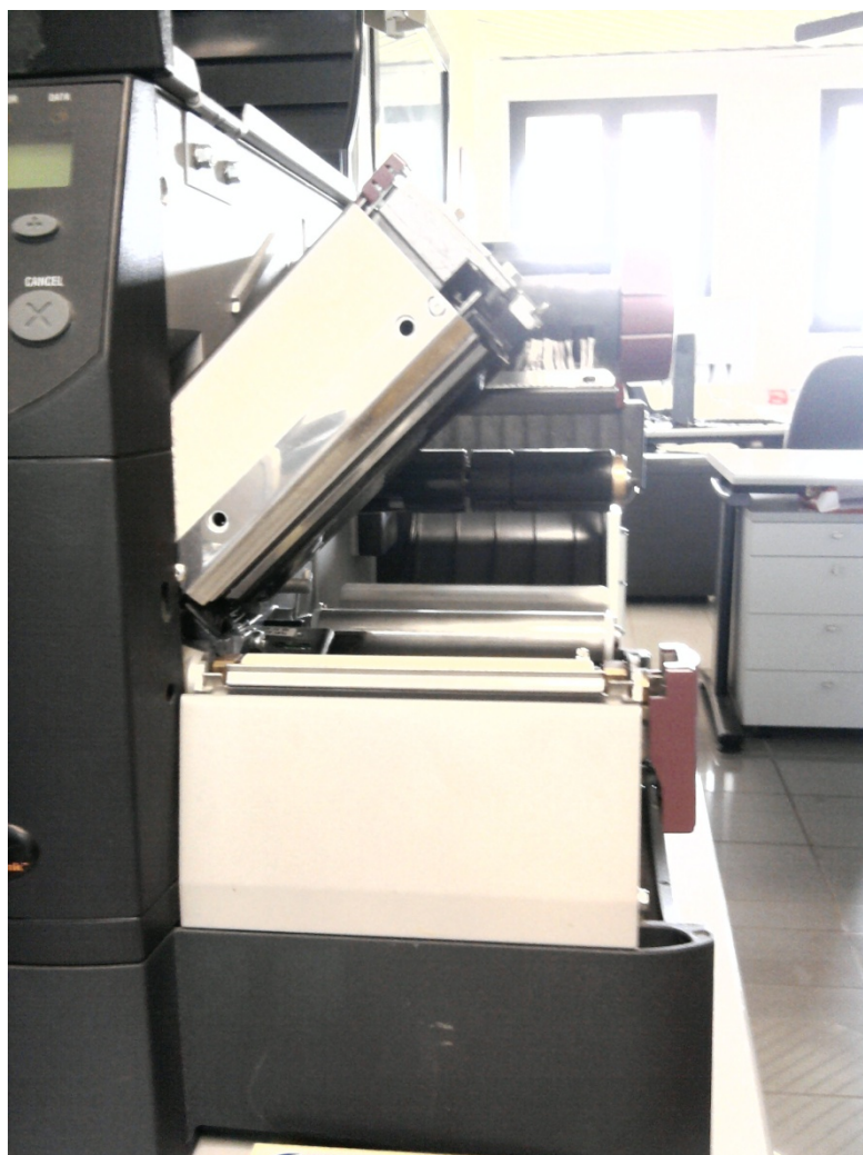
1-4 Sollevare la testina di stampa fino a fine corsa
